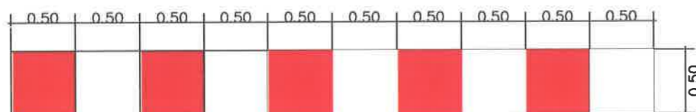
เครื่องหมายจราจรบนพื้นทาง ขาว-แดง, ขาว-เหลือง, ขาว-ดำ
