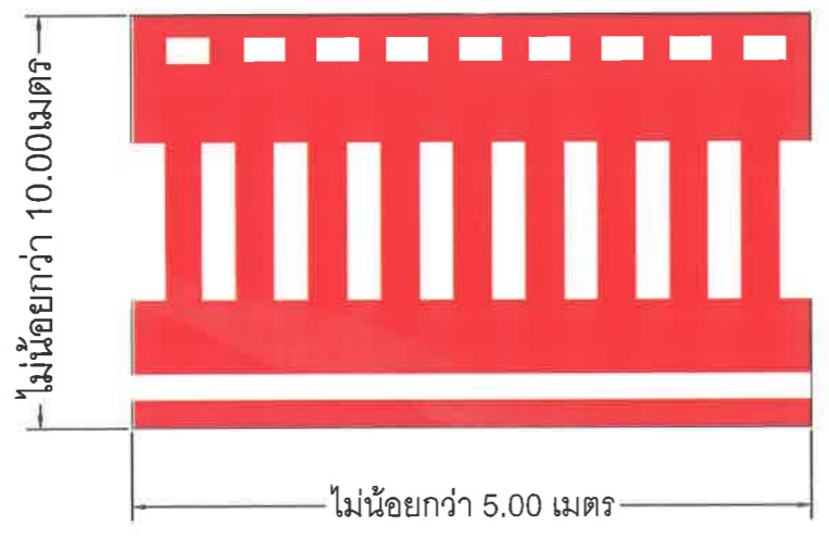
แบบขยายทางเดินคนข้าม (ทางม้าลาย) รูปแบบที่ 1
